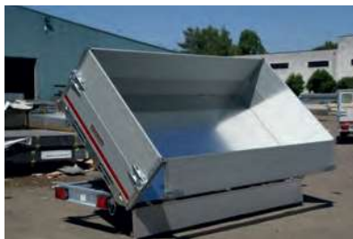
Abb. Oben scharnierverschlossene Bordwände
