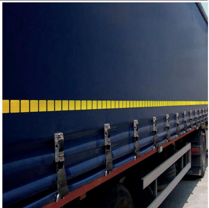
**Orafol Warnmarkierungs-Segmente** zur Konturmarkierung für Planenaufbauten und feste Aufbauten selbstklebend, gemäß ECE104 Segmentgröße 50 x 50 mm, pro Meter 18 Segmente
