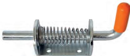
**Federringel** verzinkt, ohne Arretierung, Maße gesamt 155 x 41 x 38 mm Bolzen-Ø 12 mm, Bohrung 4 x 6,5 mm, Maße Grundplatte 72 x 41 mm
