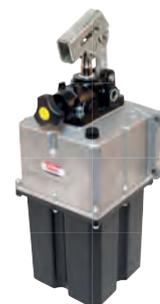
**Hydraulische Handpumpe**, doppelhub stehender Einbau, Aluminium-Gehäuse Kunststofftank 5 Liter, mit Überdruckventil Pumpenvolumen 22,5 mm<sup>2</sup>/ Hub für einfachwirkende Hydraulik-Zylinder
