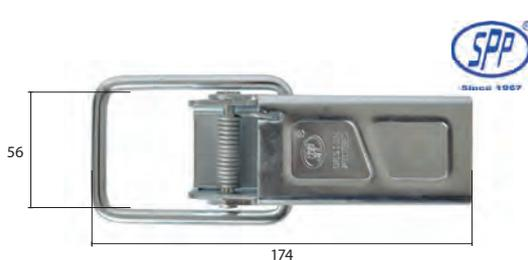
**Excenterverschluss** zum Anschrauben, verzinkt Höhe 29 mm, mit Rundbügel 7 mm, Lochabstand 30 x 20 mm Bohrungs-Ø 3 x 5 mm
