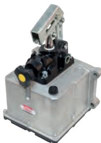
**Hydraulische Handpumpe** doppelhub, Aluminium-Gehäuse Kunststofftank 2 Liter, mit Überdruckventil Pumpenvolumen 22,5 mm<sup>2</sup>/ Hub für einfachwirkende Hydraulik-Zylinder
