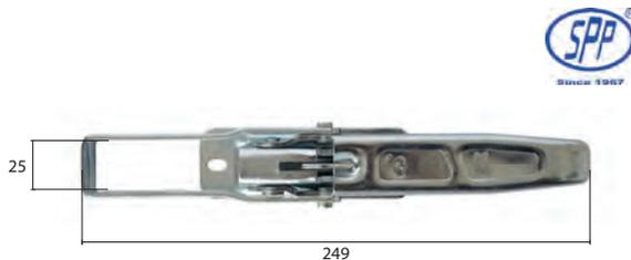
**Excenterverschluss** zum Anschrauben, mit Flachbügel 3 x 14 mm abschließbar mit Vorhängeschloss, verzinkt, Gesamtlänge 249 mm Höhe 40 mm, Lochabstand 90 mm, Bohrung 2 x 6,5 mm
