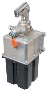
**Hydraulische Handpumpe**, doppelhub liegender Einbau, Aluminium-Gehäuse Kunststofftank 5 Liter, mit Überdruckventil Pumpenvolumen 25 mm<sup>2</sup>/ Hub für einfachwirkende Hydraulik-Zylinder mit Löseventil, Anschluss 12"L
