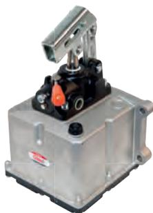
**Hydraulische Handpumpe** doppelhub, Aluminium-Gehäuse Kunststofftank 2 Liter, mit Überdruckventil Pumpenvolumen 22,5 mm<sup>2</sup>/ Hub für doppelwirkende Hydraulik-Zylinder
