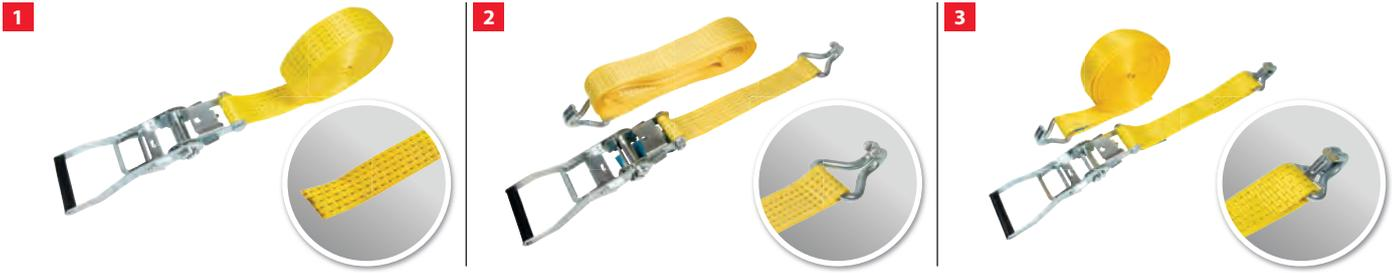
Zurrgurt mit Druckratsche, U 5000 daN, LC 2500 daN (bei Handkraft SHF 50daN - Vorspannung STF 300 daN)
