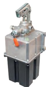
**Hydraulische Handpumpe** doppelhub, Aluminium-Gehäuse Kunststofftank 5 Liter, mit Überdruckventil Pumpenvolumen 22,5 mm<sup>2</sup>/ Hub für doppelwirkende Hydraulik-Zylinder
