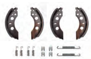
**Bremsbackensatz für eine Achse**
