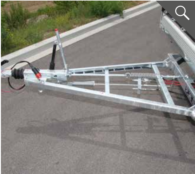
Zugdeichsel mit Drehkranz und Höhenverstellung
