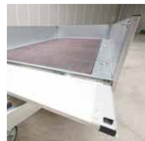
Eloxierte Aluminium-Bordwände vierseitig abklapp- und abnehmbar
