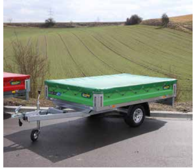
Pulverbeschichtete Bordwände mit Plane Typ P
