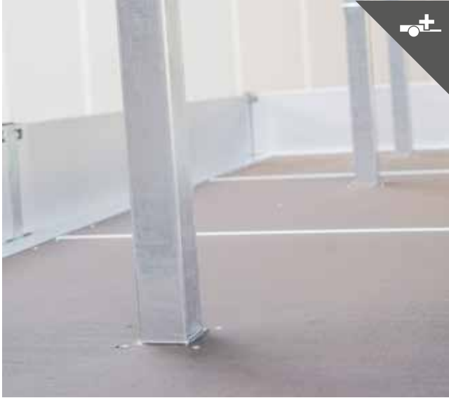
Rungentaschen mit Einsteckungen für mehr Transportmöglichkeiten
