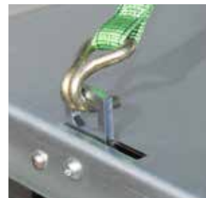
6 - 8 versenkte Zurringe mit je 600 kg Zugkraft
