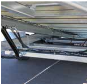
Ladefläche kippbar durch Schwerpunktverlagerung
