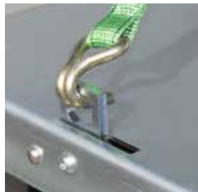
6 versenkte Zurringe mit je 600 kg Zugkraft
