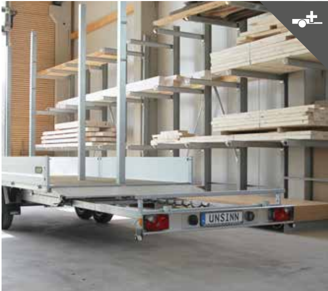
Heckleuchenträger bis 2000 mm ausziehbar
