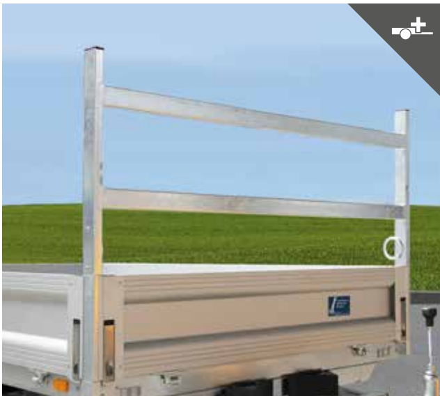
Zweireihiges H-Gestell für flexiblere Transportmöglichkeiten
