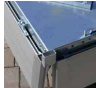
Alu-Bordwände vierseitig abklapp- und abnehmbar
