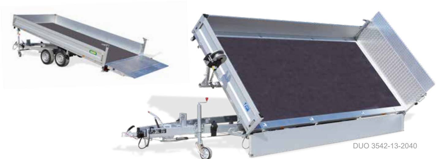
Durchgehende Stahlgitterauffahrklappe mit Alu-Riffelblech belegt
