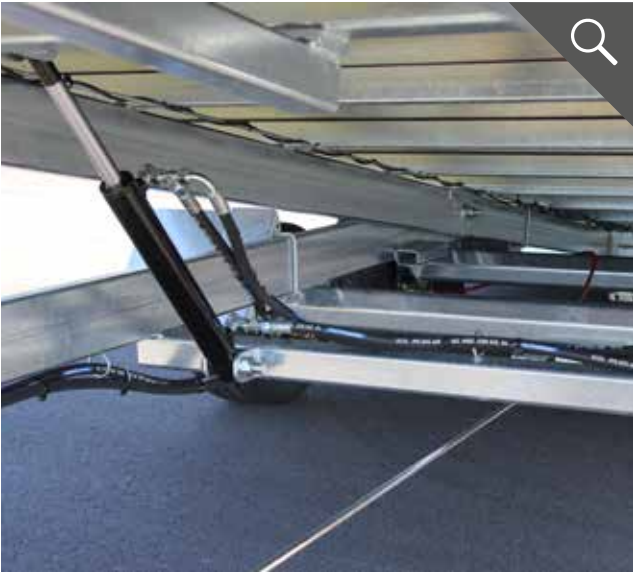
Doppeltwirkende Hydraulikzylinder für sicheres Beladen
