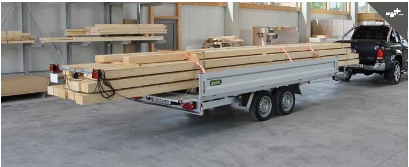
Zusätzlicher, mobiler Leuchenträger für mehr Sicherheit
