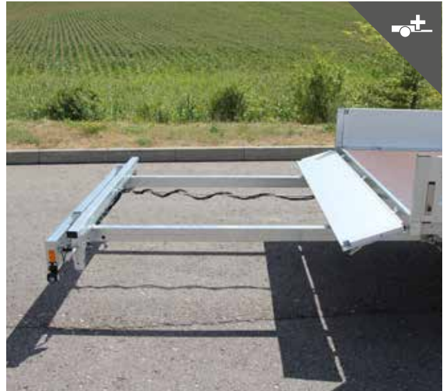
Heckleuchenträger bis 200 kg belastbar
