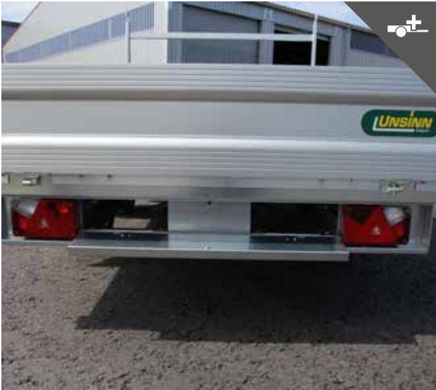
Integrierter Schacht für Auffahrschienen, elegant verstaut durch den klappbaren Kennzeichenhalter
