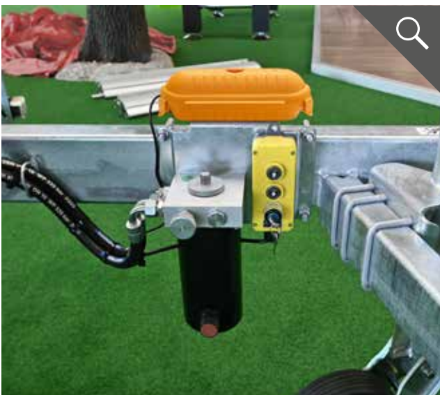
Sicherheitsbox (UDK mit Spinlock): Netzstecker und Steckschlüsseinsatz für die Notpumpe Pumpless
