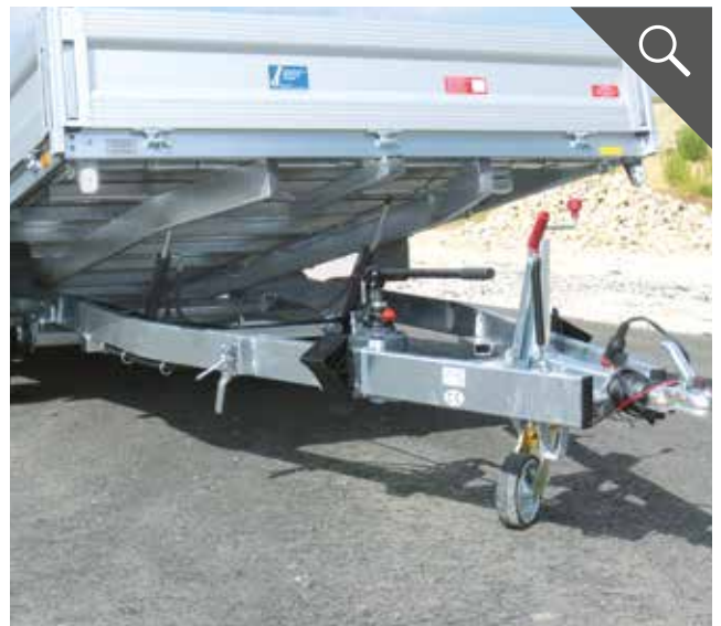
Verschweißter und feuerverzinkter Stahlrahmen
