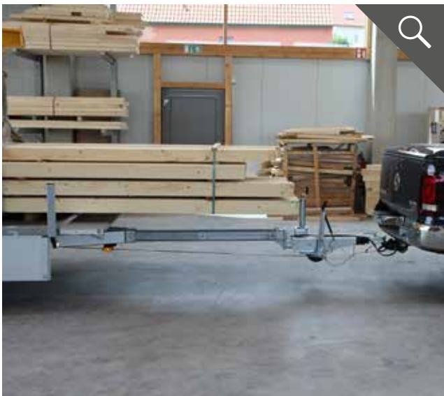
Maximale Zugdeichsellänge von 3.100 mm im Standard
