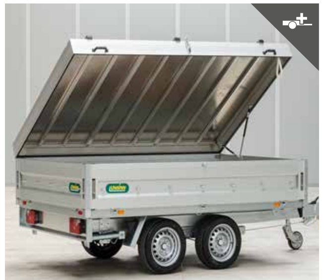
Aludeckel für den Schutz des Ladeguts
