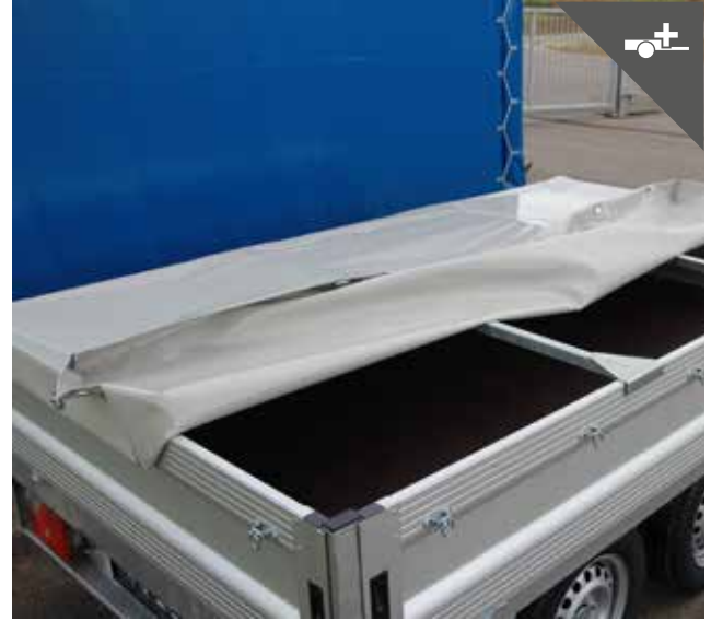
Flachplane mit Querstreben für den wetterfesten Transport
