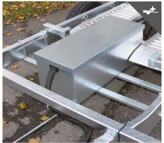
E-Hydraulik geschützt für lange Lebensdauer
