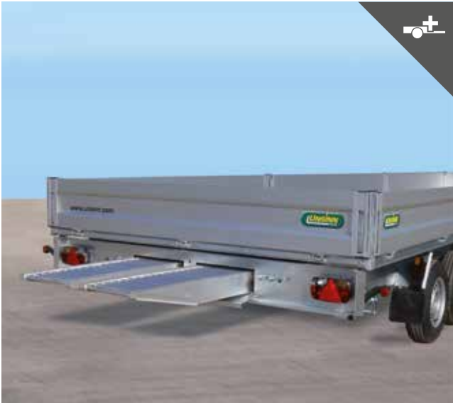
Halterung für Auffahrschienen unter der Ladefläche
