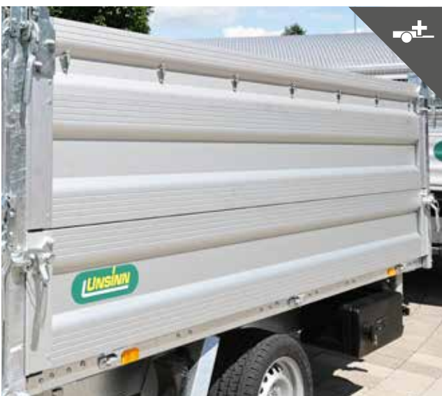
Bordwandaufsatz für mehr Ladevolumen
