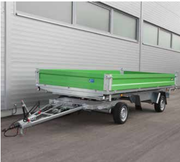
Pulverbeschichtete Bordwände Typ GDP
