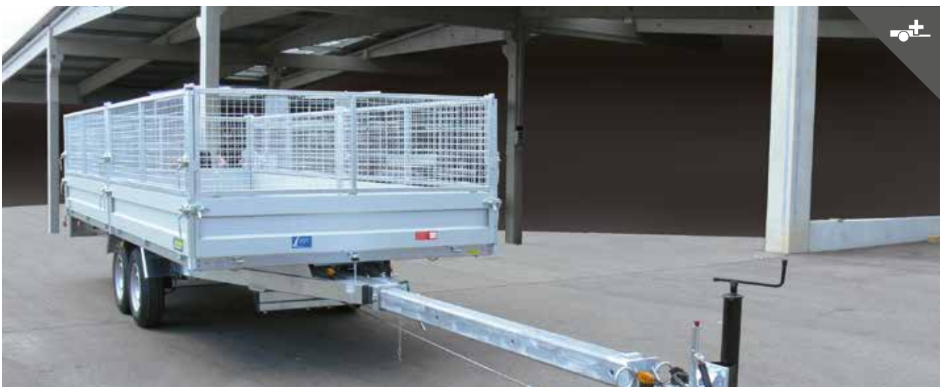
Welldrahtgitteraufsatz für mehr Ladevolumen und Zugdeichsel in Sonderlänge
