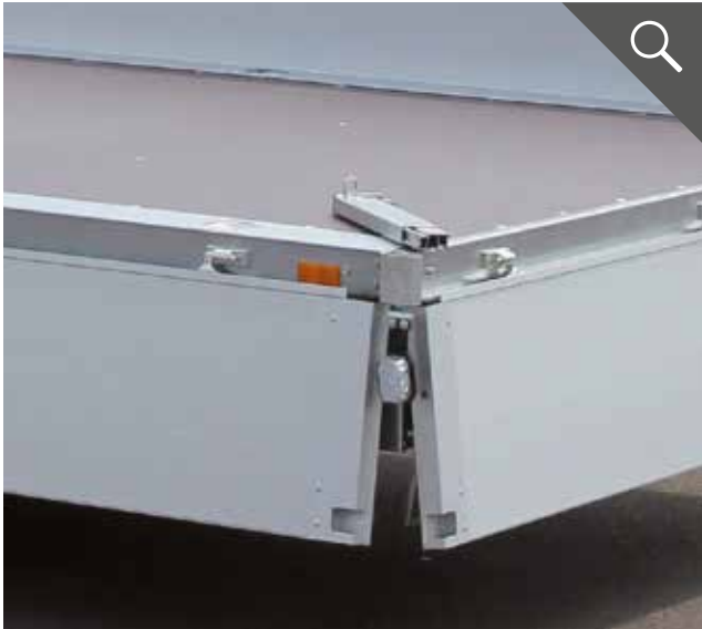
Steckbare und abnehmbare Stahl-Eckrungen für eine einfache Beladung
