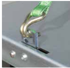
6 versenkte Zurringe mit je 600 kg Zugkraft
