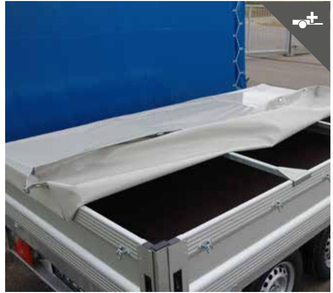
Flachplane mit Querstreben für den wetterfesten Transport
