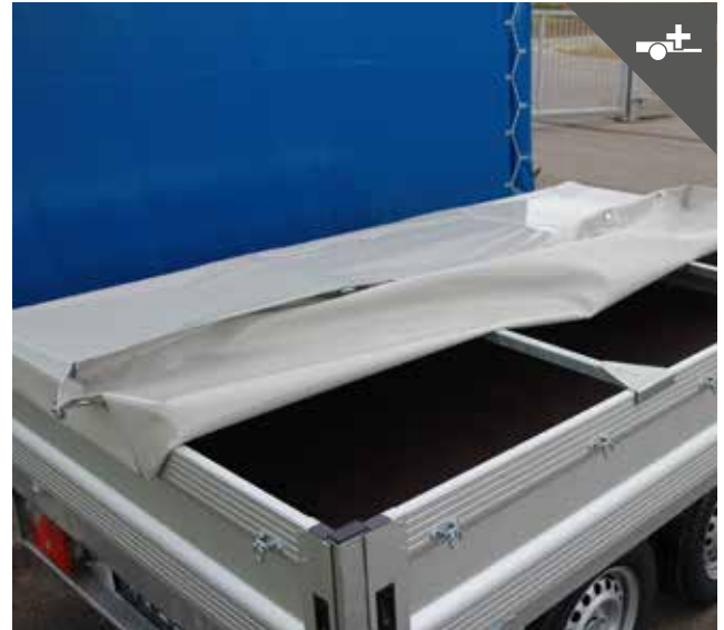
Flachplane mit Querstreben für den wetterfesten Transport
