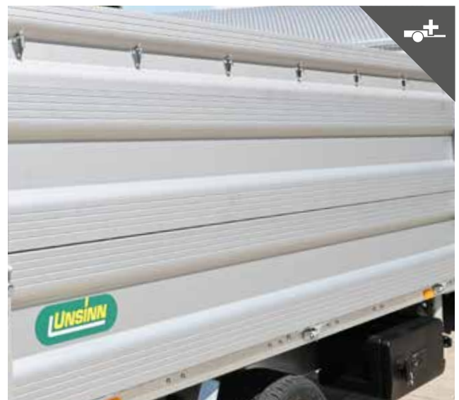
Bordwandaufsatz für mehr Ladevolumen
