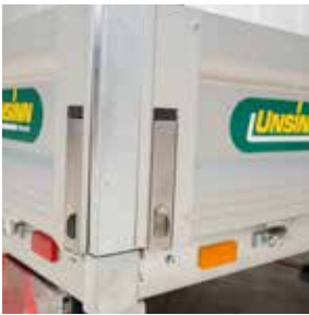
Versenkte Bordwandverschlüsse aus Edelstahl
