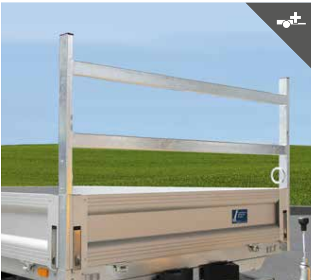
Zweireihiges H-Gestell für flexiblere Transportmöglichkeiten
