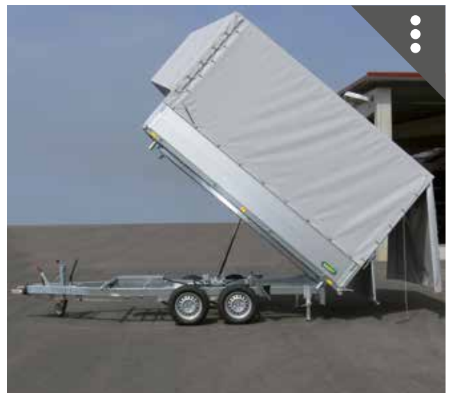
Sonderbau: Plane mit Stirnwandspitz für bessere Aerodynamik
