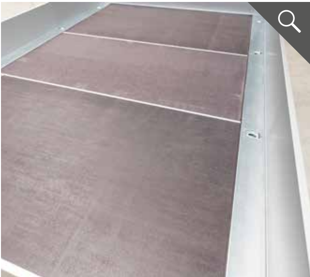
Ladefläche: Siebdruckplatte 18 mm geteilt mit Stößen
