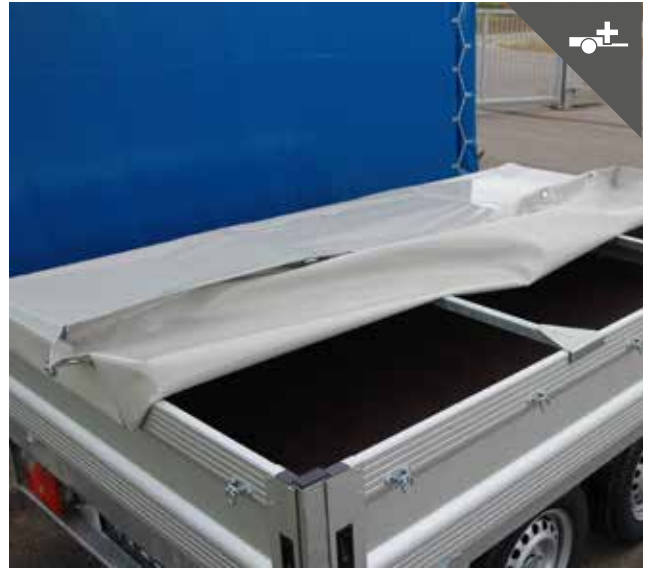
Flachplane mit Querstreben für den wetterfesten Transport
