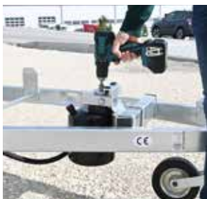
Pumpless-Hydraulik bei Kastenmaß 2,76 x 1,50 m
