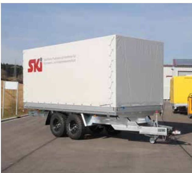
Sonderbau: Hochlader Typ GTP mit Planenaufbau und Offroadbereifung für jedes Gelände tauglich
